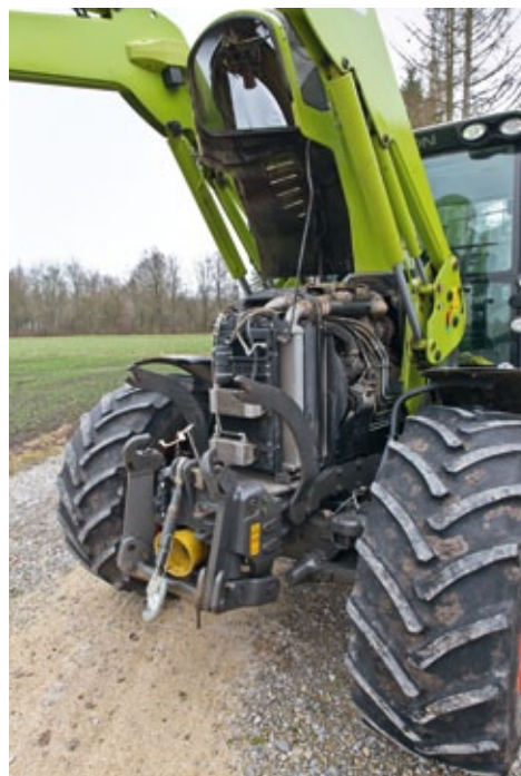
Der 6,8 l große Sechszylinder von DPS gilt als durchzugsstark, Probleme im Bereich der Kopfdichtung wurden i.d.R. behoben.
