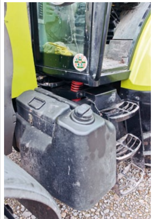
Beim Dieselverbrauch liegt das Aggregat etwas höher als vergleichbare Wettbewerber, die 330 l Dieselvorrat sind dafür okay.
