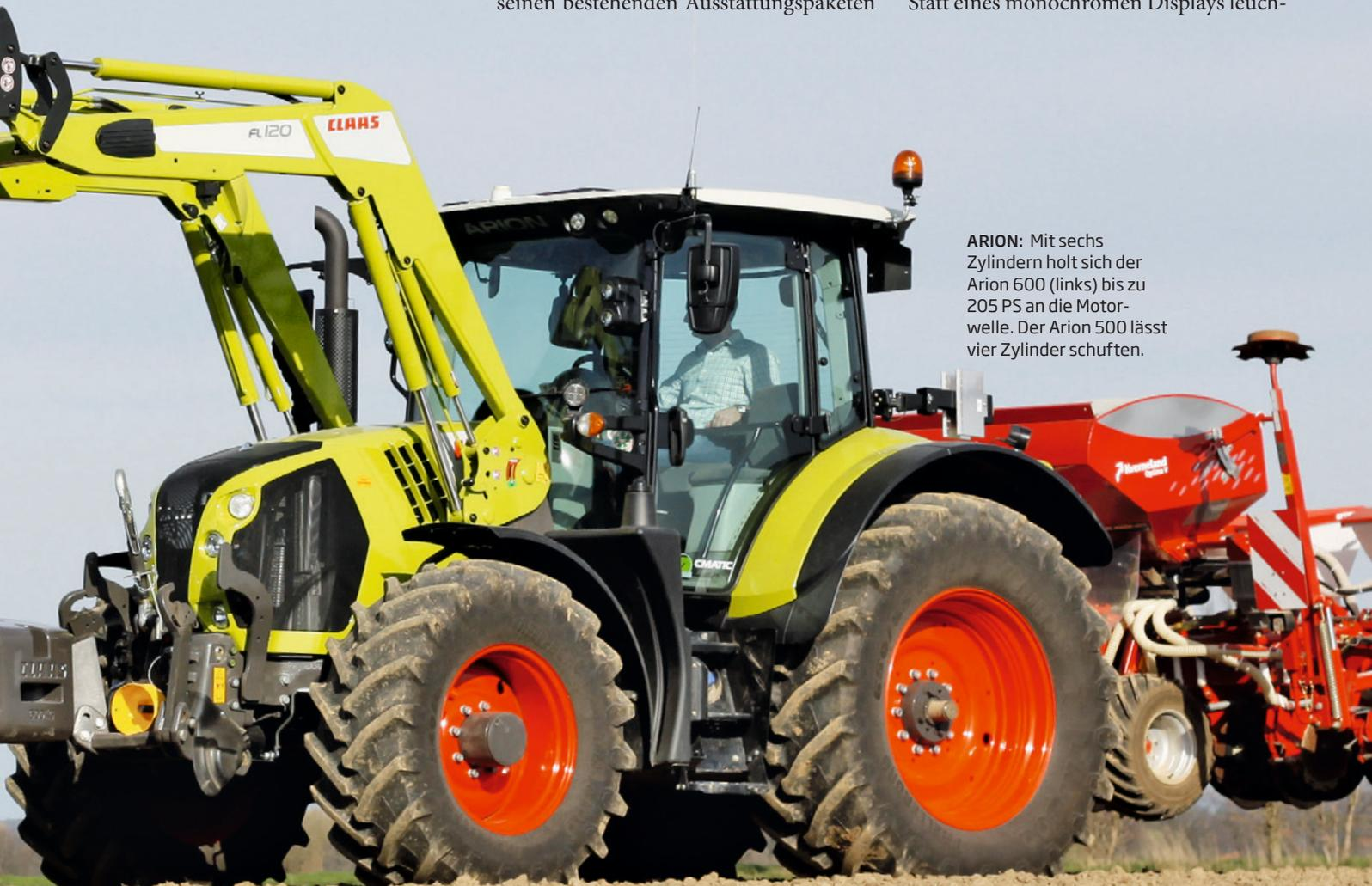
**ARION:** Mit sechs Zylindern holt sich der Arion 600 (links) bis zu 205 PS an die Motorwelle. Der Arion 500 lässt vier Zylinder schuffen.
