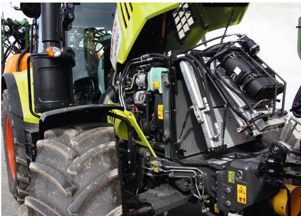
Der Motorhersteller Deere-Power-Systems liefert die Triebwerke für alle Arion 500 und 600 – sowohl 4- als auch 6-Zylinder. Der Motorraum wurde besser abgedichtet.
