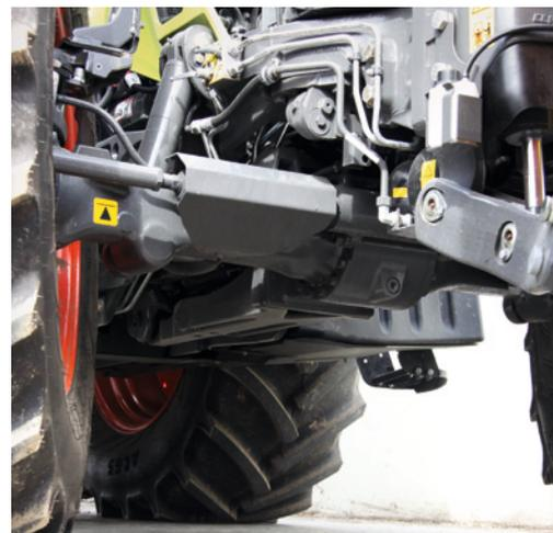
Starre Achse, zwei doppelwirkende Hydraulikzylinder und eine Schwinde bis unter die Mitte sind die Komponenten der neuen Achsfederung.
