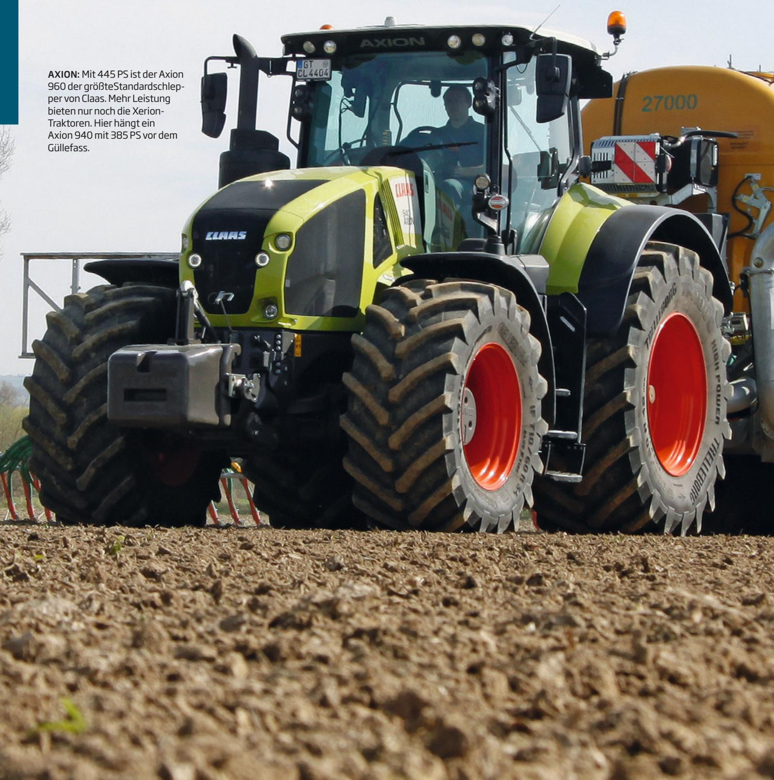
Die Axions sind nach ihrer ersten Vorstellung 2011 weltweit gut angekommen. Auffälligstes Merkmal der Neuen: Anders geformte Luftschlitze auf der Motorhaube pusten die Abwärme weg von der Kabinenfront, außerdem fällt der dicke Topf am Endrohr auf. Hier sitzt die größer gewordene SCR-Technik. Der Cursor-9-Motor bleibt gleich, bekommt aber einen variablen Turbolader für mehr Muckies bei tieferen Drehzahlen und grummelt jetzt im Stand mit niedrigen 650 U/min. Außerdem feilten die Ingenieure an
