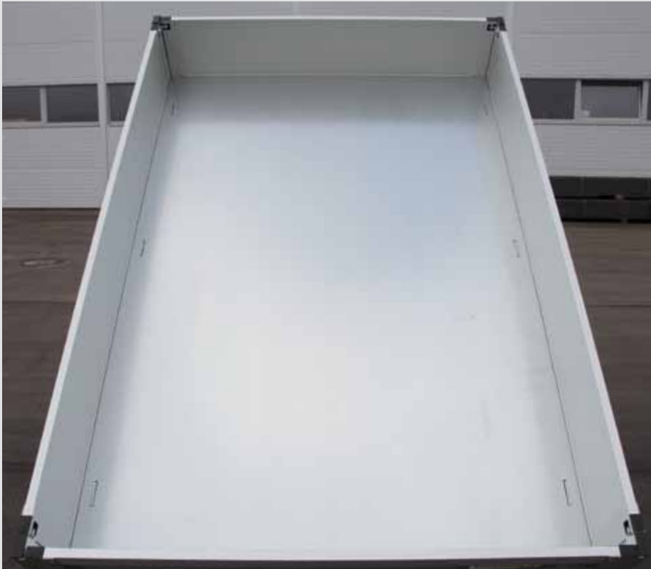
Stahlboden mit versenkten Zurringen
