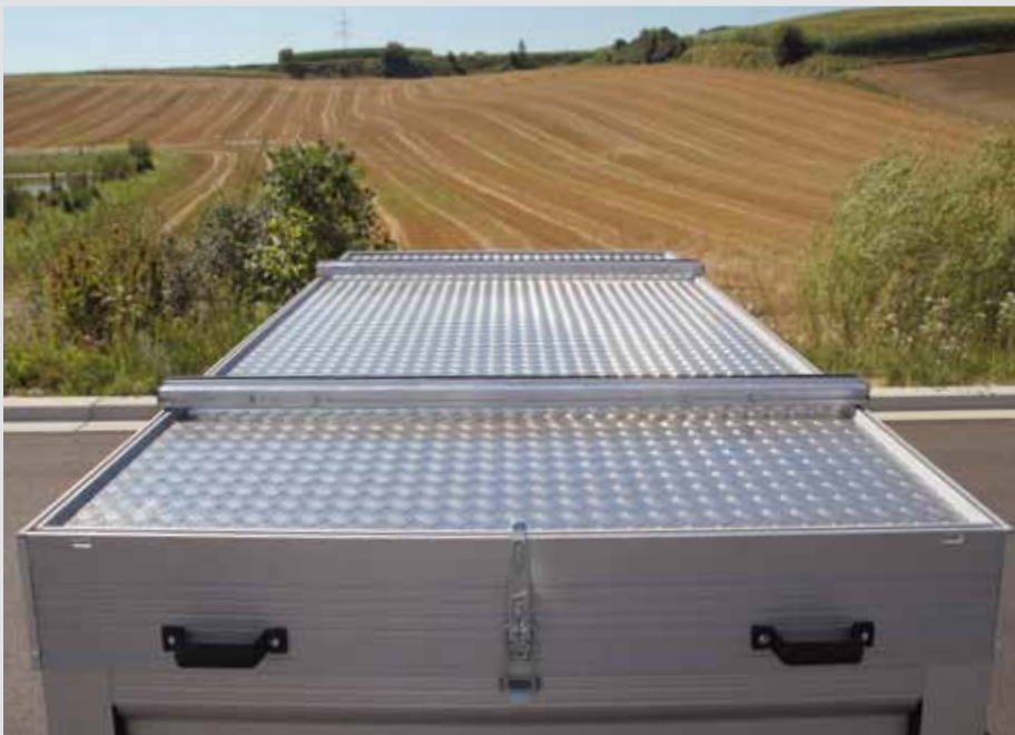
Alu-Deckel mit Querträger für variable Befestigungsmöglichkeiten
