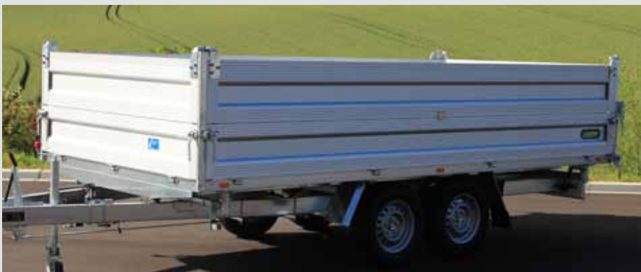
Bordwandaufsatz im gleichem Aluprofil wie Grundbordwand
