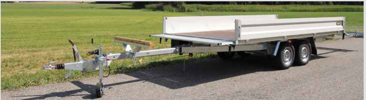
Auflagebock auf Zugdeichsel flexibel montierbar
