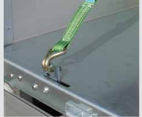
versenkte Zurringe (Stahlboden)
