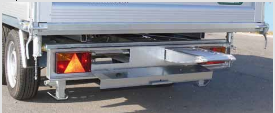
ausziehbare Auffahrschienen mit Spanneinrichtung unter der Ladefläche
