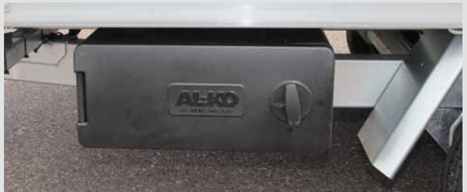
Werkzeugkasten unter der Ladefläche montiert
