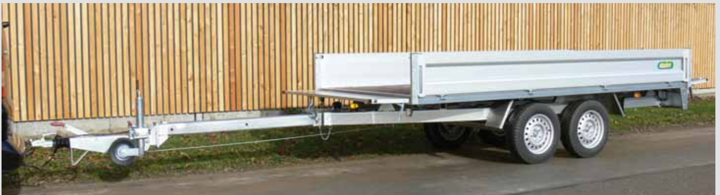
Zugdeichsel ausziehbar (ohne Werkzeug)
