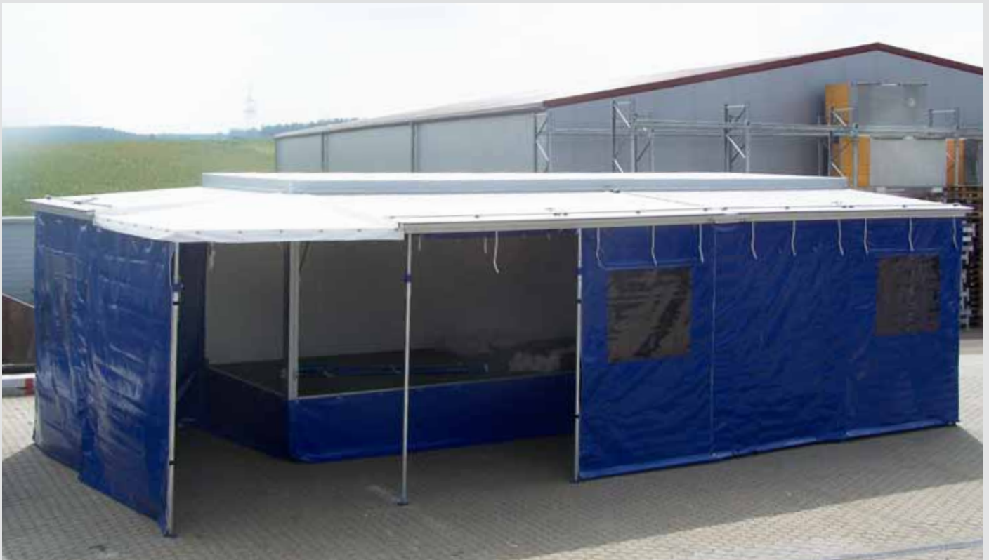
Planenvorzelt in Verbindung mit Kofferaufbau
