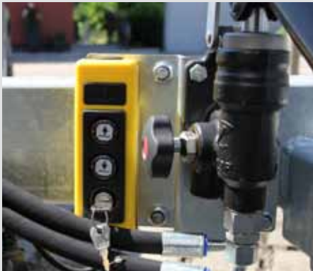
E-Hydraulik mit Nothandpumpe
