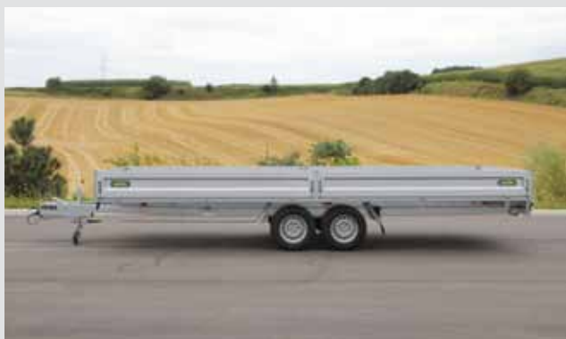
Bordwände mit Mittelrungen (ab Innenlänge 5460 mm)
