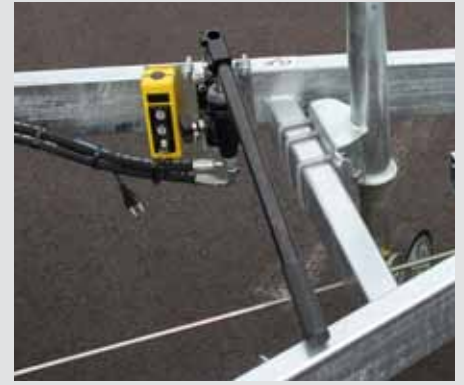
E-Hydraulik mit Not-Handpumpe
