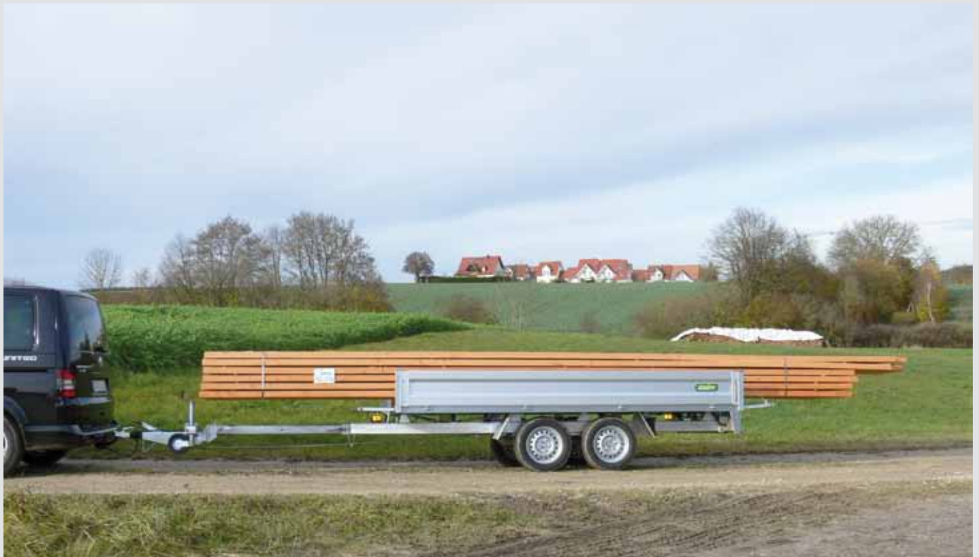
maximale Zugdeichsellänge von 3100 mm im Standard
