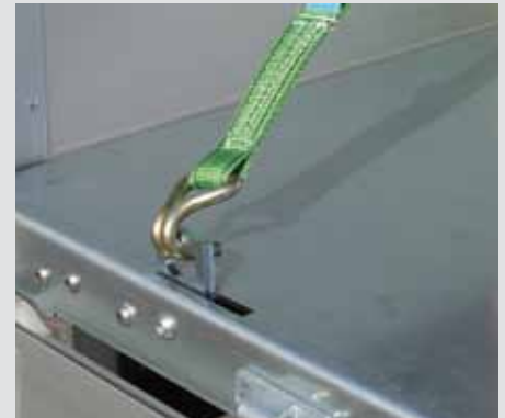
versenkte Zurrringe (Stahlboden)
