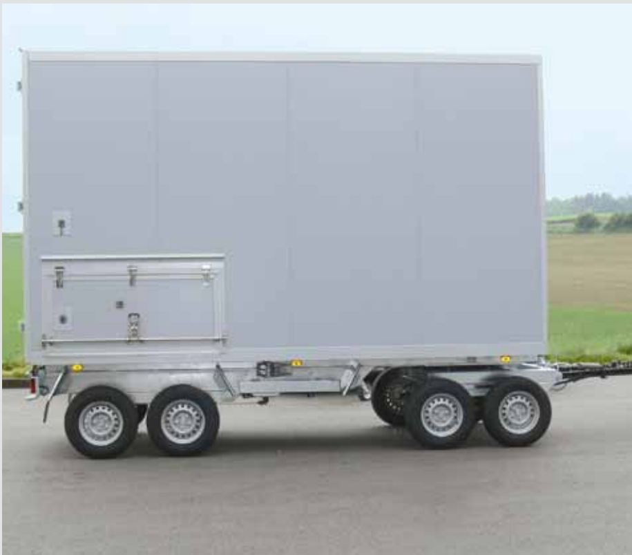
4-achsig mit Kofferaufbau
