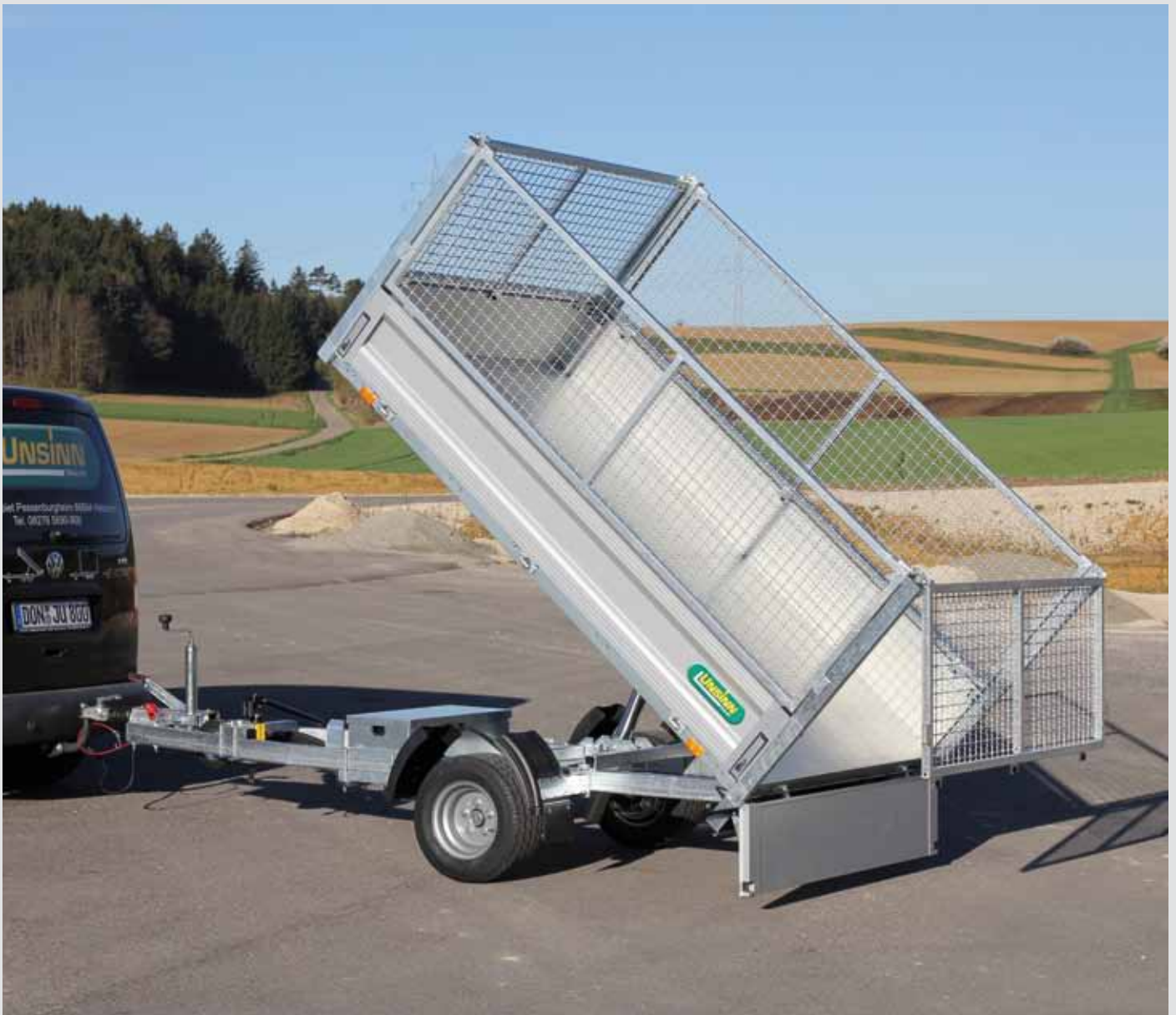
Welldrahtgitteraufsatz (4-seitig pendelnd gelagert)
