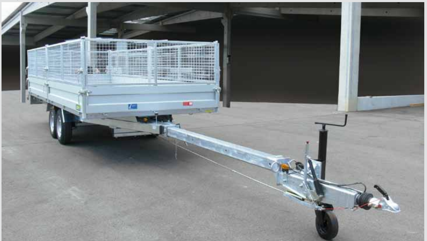
Welldrahtgitteraufsatz und Zugdeichsel in Sonderlänge
