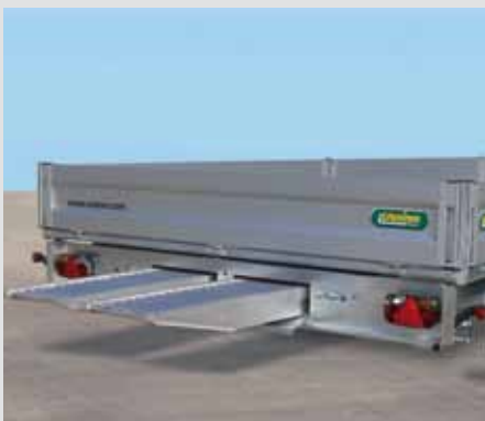
Auffahrschienen mit Halterung unter der Ladefläche
