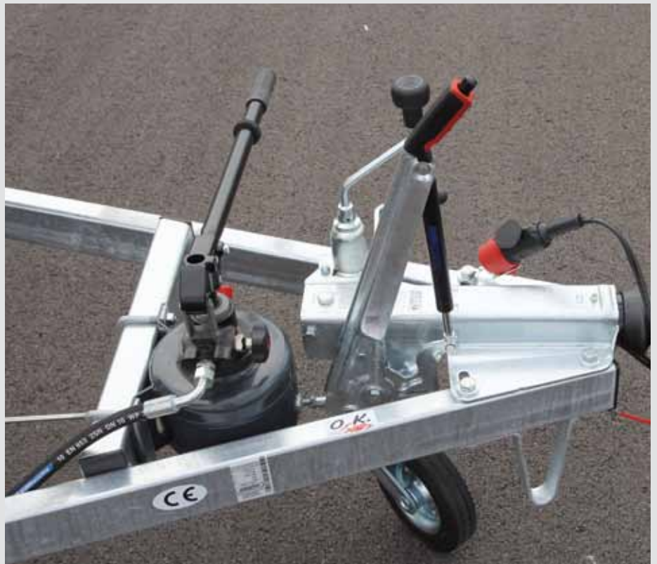
Handpumpe mit hydraulischer Kippeinrichtung
