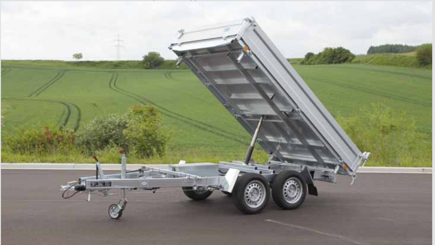
stabile und verschweißte Rahmenkonstruktion mit optimalem Nutzlastverhältnis
