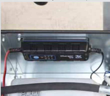
Hochfrequenzladegerät mit Erhaltungsladefunktion
