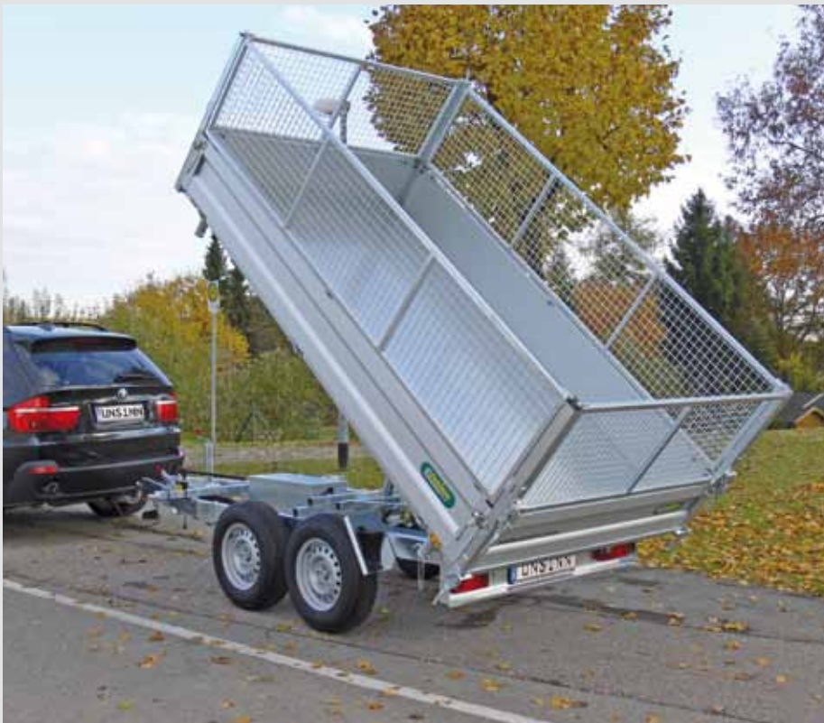
Welldrahtgitteraufsatz (4-seitig pendelnd gelagert)
