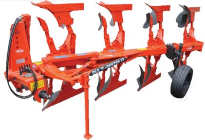
Anbauvollandrehpflüge MULTI-MASTER 113, 4-furchig, 35/40/45 cm Arbeitsbreite in Stufen/ Schar, Rahmen 120x120, Kombieinstellung, NP-Körperform, MARATHON-Schare und Scharspitzen, TRIPLEX-Streichbleche, Einleger DU, Stützrad Stahl
