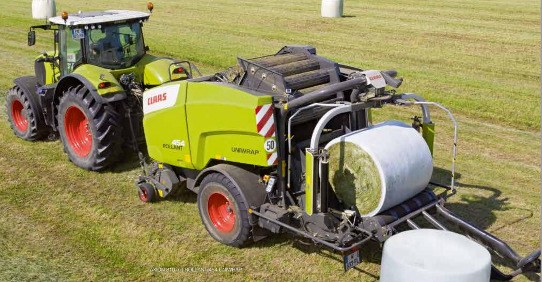
AXION 810 mit ROLLANT 454 UNIWRAP
