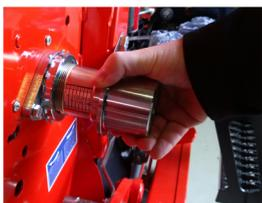
**+** Präzisionsdosierung HELICA Zellenrad-dosierung sorgt für äußerst gleichmäßige Aussaat
