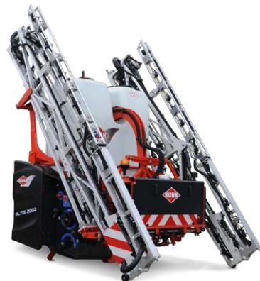
Durch Kombination der ALTIS 2 mit unserem Fronttank PF, wird aus der Anbaufeldspritze ein kompakter Selbstfahrer mit bis zu 3.500l Fassungsvermögen. Die optimierte Gewichtsverteilung und das gedämpfte Gestänge ermöglichen einen hohen Fahrkomfort auch mit vollem Behälter. Die ISOBUS-Integration der Maschine bietet eine flexible Steuerung beim Einsatz mit unterschiedlichen Traktormodellen.
