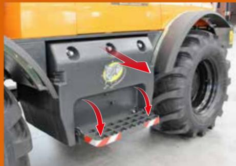
Hydraulisch ausfahrbares Kontergewicht mit Trittstufe
