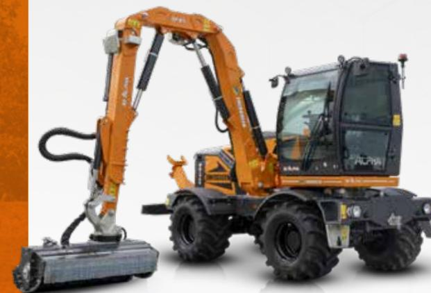
Der Teleskopausleger **3P** hat eine robuste und kompakte Struktur. Er besteht aus 3 Teilen, um typische Hindernisse bei der Arbeit auf Straßen überwinden zu können. Durch seine ideale Bauweise eignet er sich außerdem für Arbeiten an Gewässern und Kanälen mit Mähkorb und Räumlöffeln.
