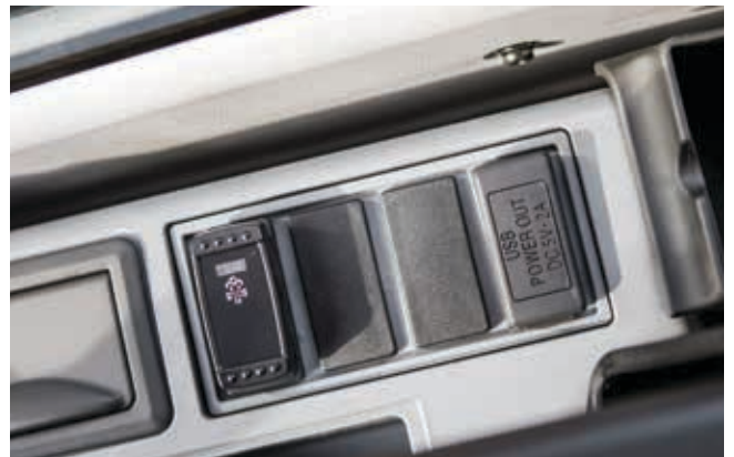
Der USB-Stromversorgungsanschluss ist nützlich zum Aufladen von tragbaren Geräten wie beispielsweise Mobiltelefonen.
