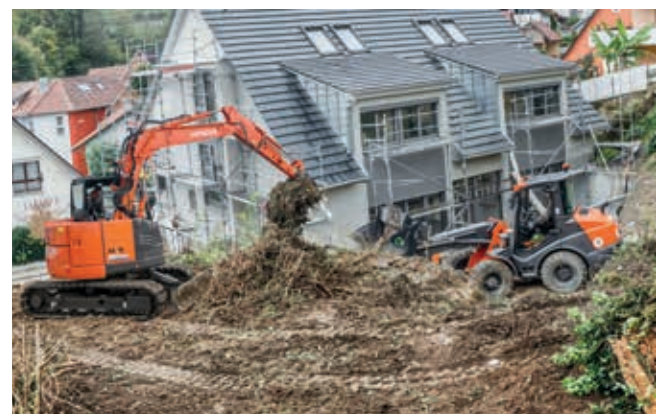
Dank des kleinen Heckschwenkradius ist der ZX85US-6 ideal für Arbeit auf engem Raum.
