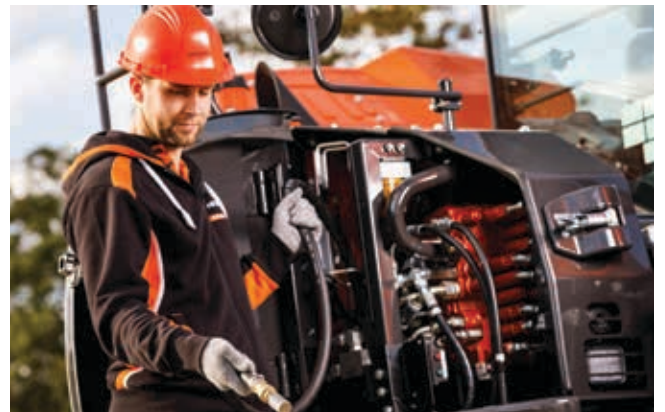
Der Bagger kann mit einer elektrischen Pumpe betankt werden.
