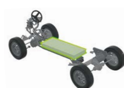
Reichweitenpaket (23 kWh Batterie) Die mittlere Batterie mit 23 kWh erhöht die Reichweite auf bis zu 150 km (WLTP).
