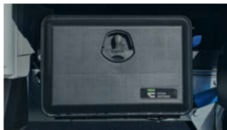
Toolbox Abschließbare Werkzeugbox unter der Pritsche. Volumen: 30l.
