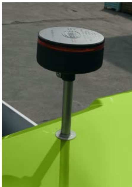
LED Rundumleuchte inkl. Innenraumbedienung und DIN Warn-/Reflektionsfolien Kennzeichen das aCar für Gefahrensituationen klar sichtbar als Kommunalfahrzeug.
