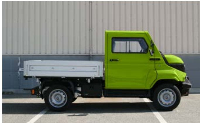
Pritsche Platz für zwei Europaletten. Sechs Zurrösen für die Ladungssicherung.
