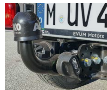
Abnehmbare Anhängerkupplung Gebremst 1.000 kg / ungebremst 750 kg / 70 kg Stützlast.
