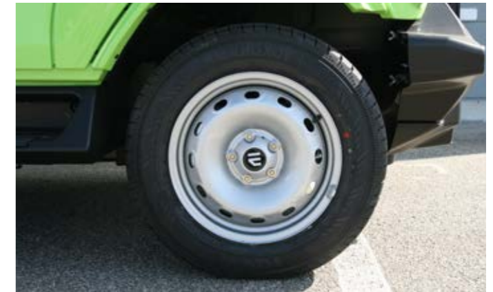
Sommer-, Winter- und Ganzjahreskomplettreäder 185/75R16C, Felge: 6Jx16 Stahlfelge (alle Räder schneekettentauglich)
