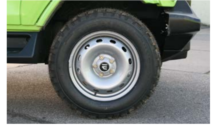
Geländekomplettreäder 185/75R16C, Felge: 6Jx16 Stahlfelge
