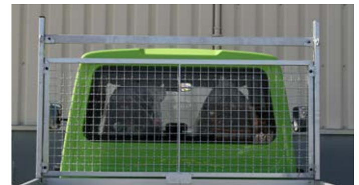
Aufprallschutzgitter Schutz von Fahrgastzelle und Heckfenster beim Transport von Langgut.
