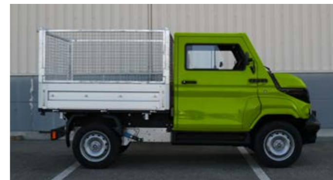
Pendelgitter Höhere Bordwände für größeres Ladevolumen.
